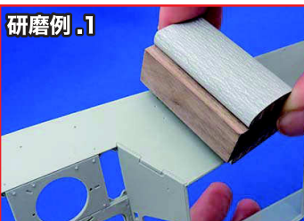
●サンドペーパーを巻き込み、 角棒を押し込むだけ。 カドRを下に!
