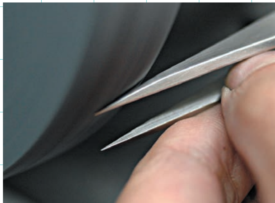
●手作業による先端側面最終仕上げ
